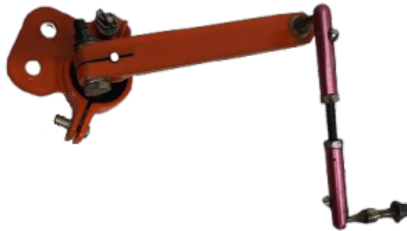
(b) Mecanismo projetado para representar a cinemática de movimento da superfície de comando
